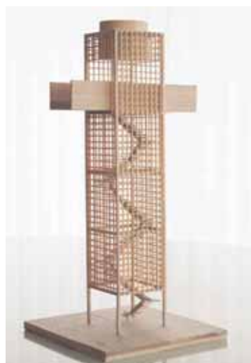
TÅKETÅRN MED HENGENDE TRAPP: Tårnet har en oppsamler av vann. En struktur med dyser aktiveres om morgnen og ettermiddag. En hengende trapp i wire fra broen møter en gangvei og gjør broen tilgjengelig fra bakkeplan.
